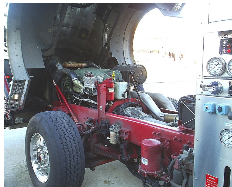
13. Die gekippte Mannschaftskabine gibt den Blick auf viele Details frei, die leider am Modell, wie Reifengröße, Lenkung, Motor und Getriebe, nicht zu finden sind. Foto: M.Schaefer CPVFD
