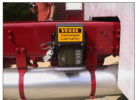
11. Details für das Modell, Vogel Zentralschmierung. Die Rückwand der Mannschaftskabine bekam keinen Lack, da sie durch eine Riffelblechplatte ersetzt wurde. Foto: M. Schaefer CPVFD
