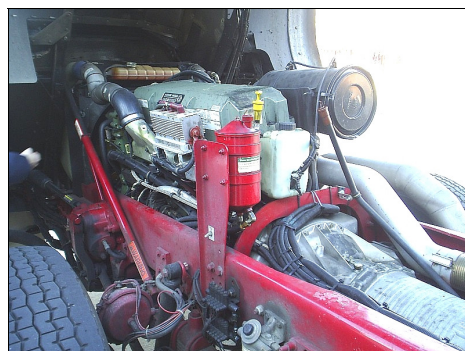
14. Angetrieben wird Engine 121 von einem 500 PS starken Detroit Diesel aus der 60er Serie. Dahinter das Allison Automatikgetriebe HD 4060 P.
