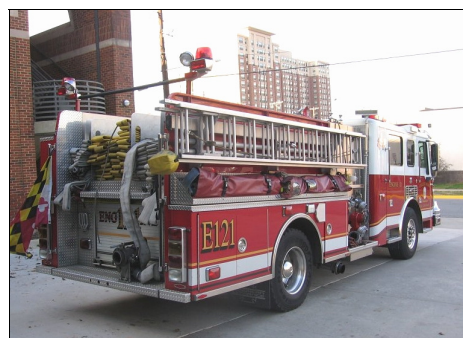
07. Typisch für amerikanische Feuerwehrfahrzeuge, die zusammengefalteten oder auch gerollten Schläuche in verschiedenen Größen. Foto: M.Schaefer CPVFD
