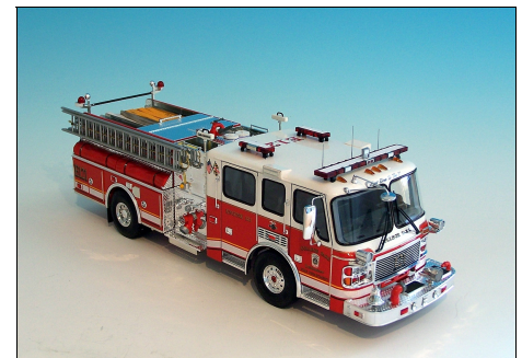
27. Der vordere Signalbalken wurde komplett erneuert und ist nicht mehr hohl. Die Sirene bekam eine feine Gitterstruktur und wird später gegen ein Fotoätzteil ausgetauscht. Foto: Klaus Lassen
