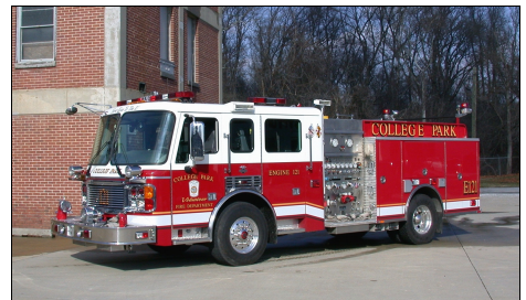
23. Am neuen Fahrzeug sind die vielen verchromten Bauteile und Verkleidungen gut zu erkennen. Auffallend die Radläufe, Einstiege und Riffelbleche am Aufbau. Foto: Frederick Brower CPVFD
